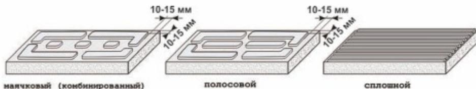
А посередине плиты в двух или четырех местах – маячки диаметром 100 мм. Или наносятся на плиту только маяки диаметром 100 мм (на плиту размером 0,5 м x 1,0 м – 6-8 маяков);
